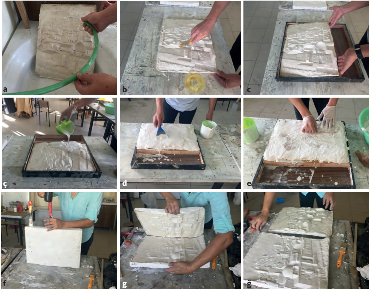
Görsel 3.104: Negatif kalıba pozitif döküm aşamaları
