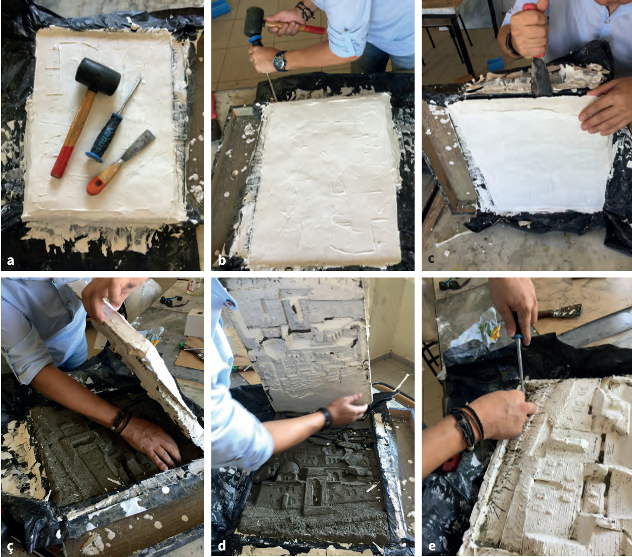
Görsel 3.103: Kalıp açma aşamaları
