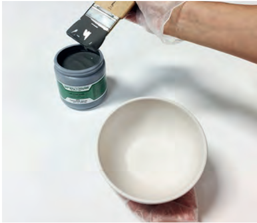
Görsel 4.62: Fırça ile sırlama yöntemi
