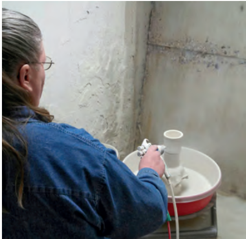
Görsel 4.63: Püskürtme yöntemi
