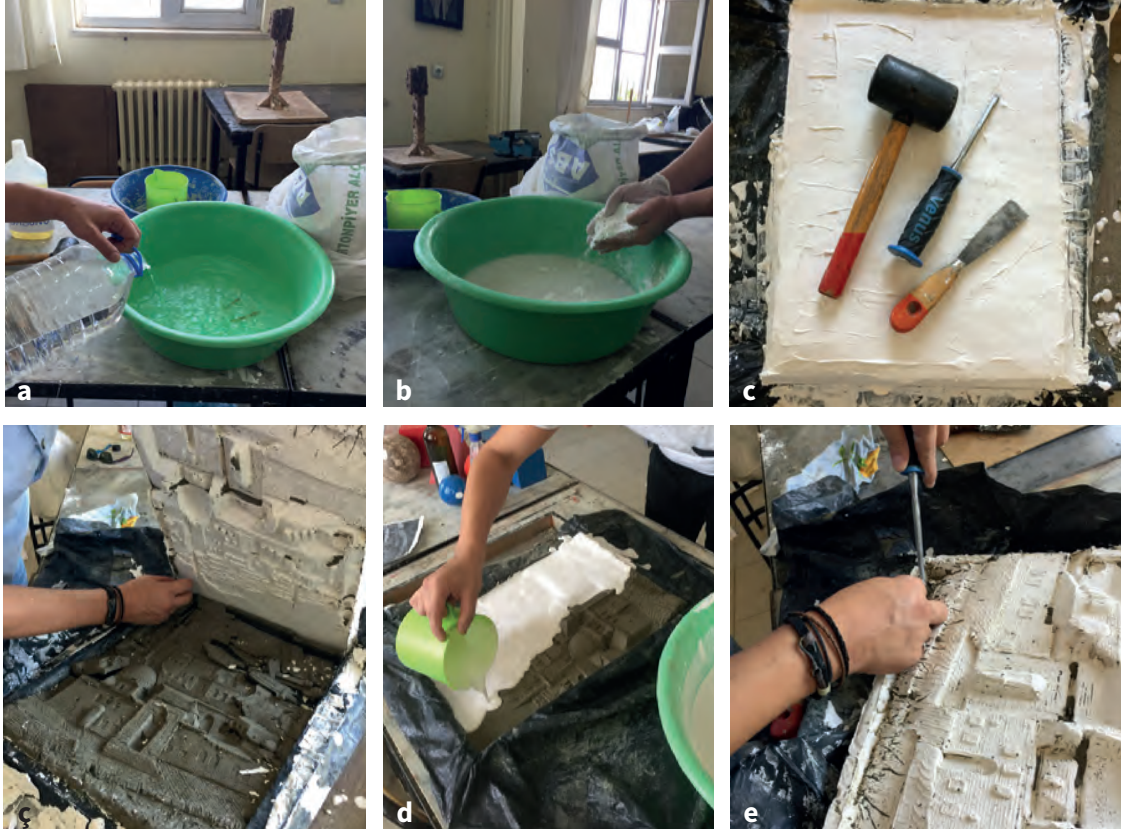
Görsel 3.96: Alçı kalıp alma ve döküm işlemleri
