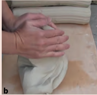
Görsel 4.46: Öküzbaşı tekniği ile kil yoğurma aşamaları
