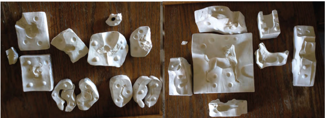
Görsel 2.51: Çok parçalı çoğaltma kalıbı
