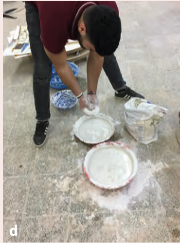
Görsel 2.65: Açılan kalıbın hazırlık ve pozitif döküm aşamaları
