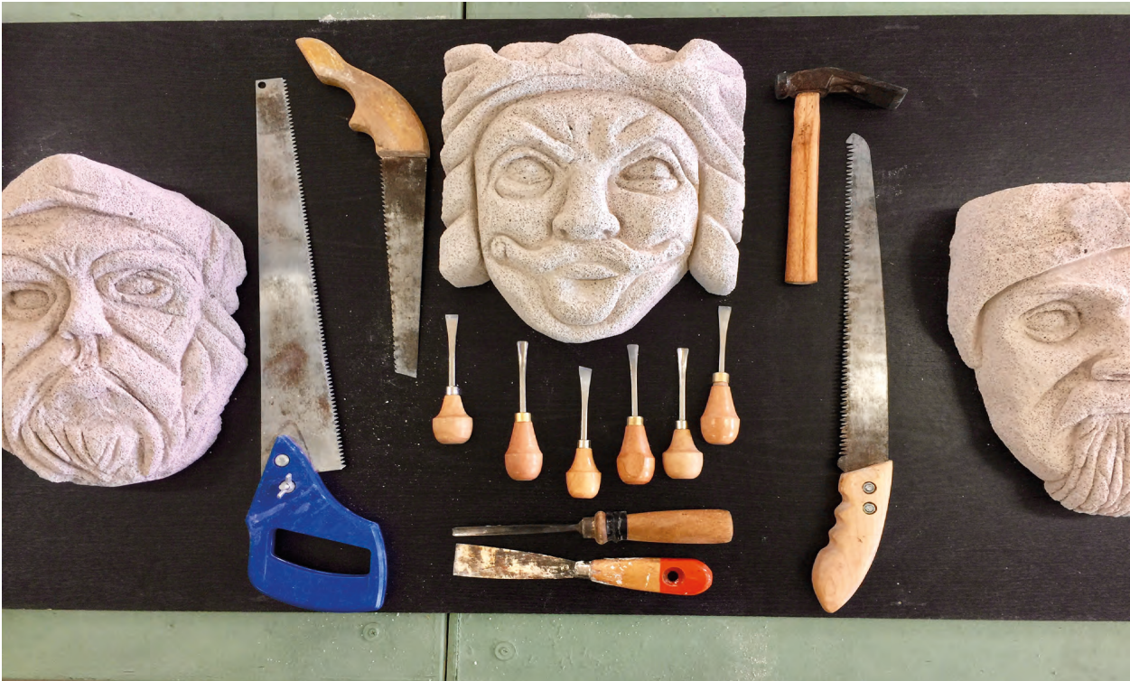
Görsel 3.4: Gaz beton yontuda kullanılan araç-gereçlerden bazıları
