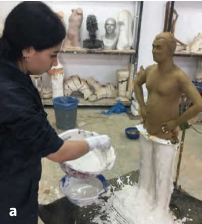
Görsel 4.13: Uygulamanın negatif kalıbının alınması
