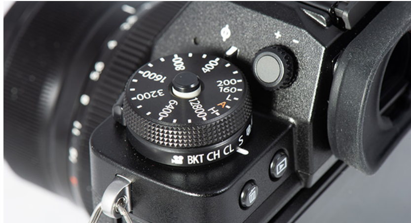
Görsel 6.11. Fujifilm X-T3 Makine Gövdesi Üzerinde ISO Ayar Tuşu (photographynews.co.uk)
