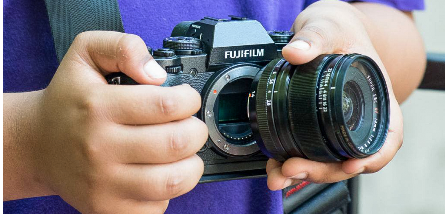
Görsel 4.3. Objektif Yuvasına Lensi Yerleştirme (photar.ru)
