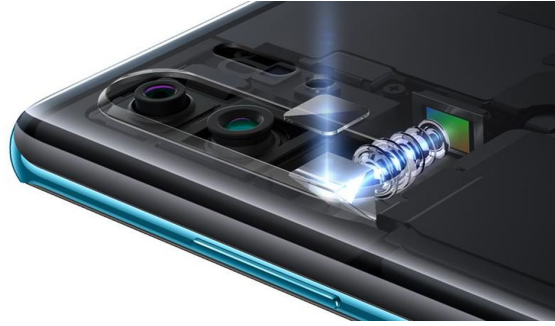
Görsel 3.8. Cep Telefonu, Huawei p30 Pro Lens ve Algılayıcı Kesiti (forbes.com)
